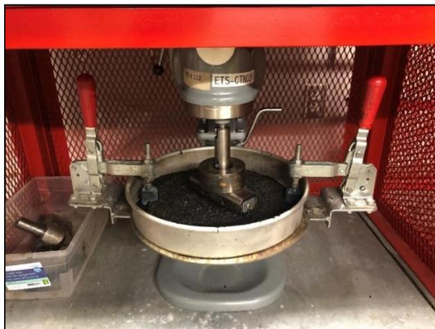
Figure 2-6: Dispositif expérimental de l'essai d'abrasion humide
