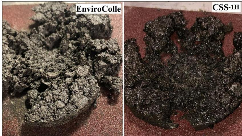
Figure 3-11: Différence entre un mélange préparé avec EnviroColle (à gauche) et CSS-1H (à droite)
