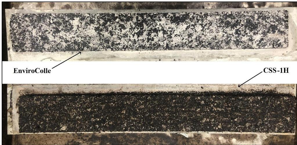
Figure 3-13: Différence entre deux échantillons préparés avec CSS-1H et EnviroColle
