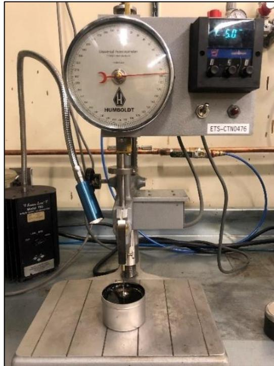
Figure A-I- 2: Dispositif expérimental de l'essai de pénétrabilité à 25°C, 100g, 5s
