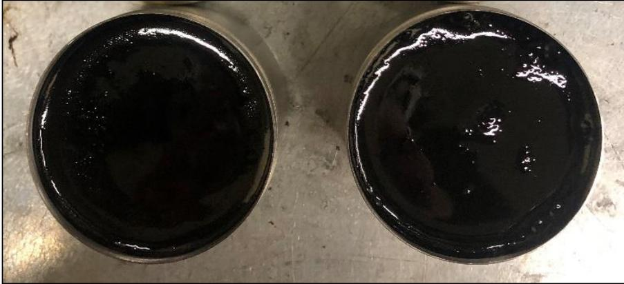
Figure A-I- 1: Echantillons de résidu préparé pour l'essai de pénétrabilité
