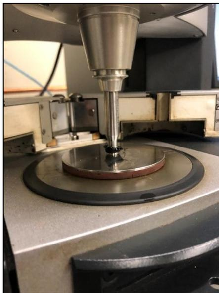
Figure A-I- 3: Essai DSR sur le résidu récupéré sur une plaque de granit
