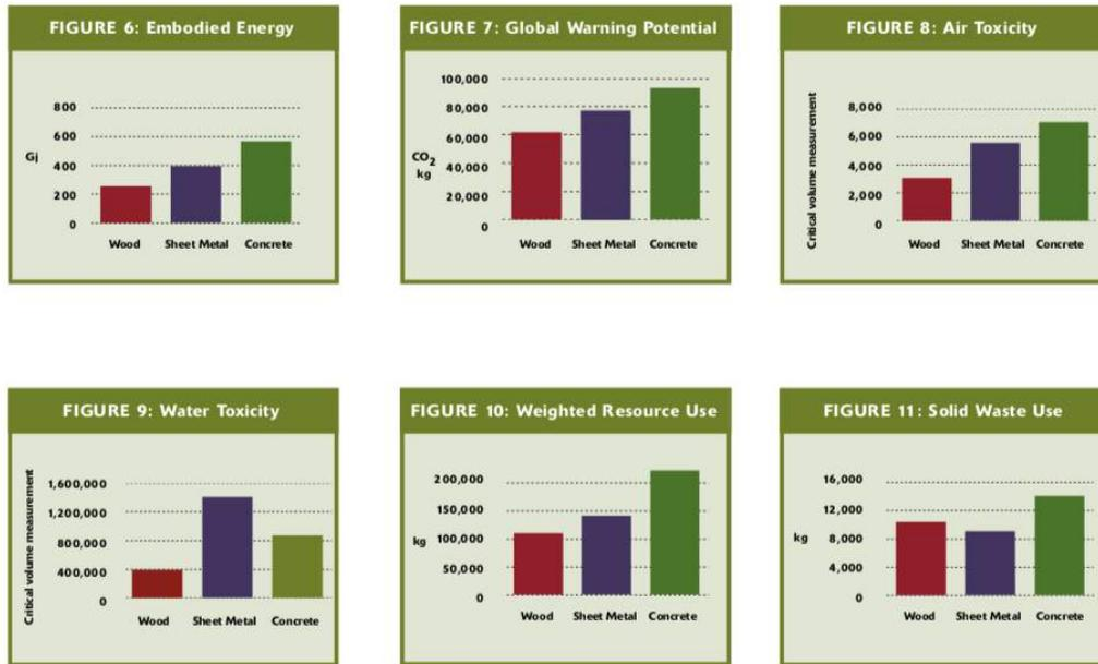
Figure 2.10 Comparaison des impacts environnementaux d'un bâtiment de trois étages avec structure en bois, acier ou béton (tiré Canada Wood, s.d.)
