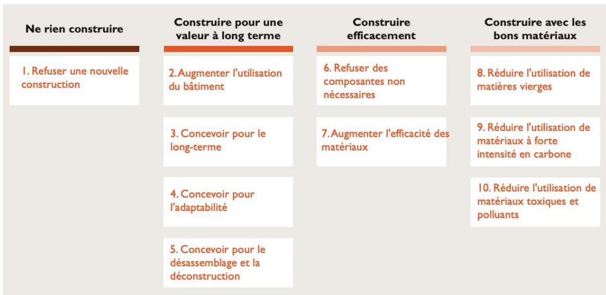
Figure 3.1 Stratégies et actions de circularité dans la conception des projets de construction (tiré d’ARUP, 2022)
