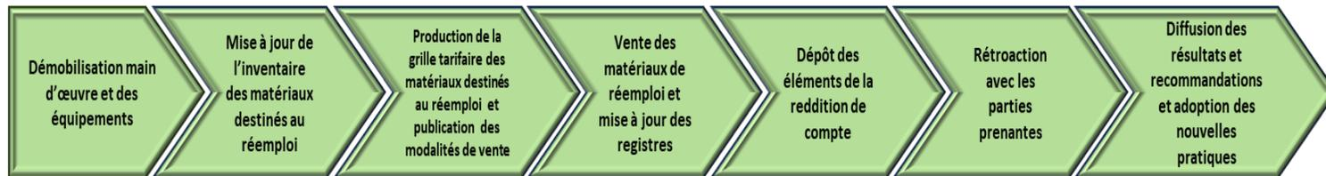
Figure 3.5 Processus simplifié de la phase de post-déconstruction
