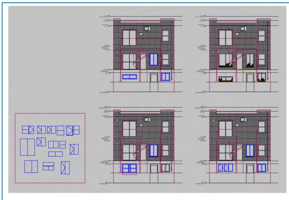
Figure 36 : Représentation d'un lot de fenêtres préalablement mesurées chez RÉCO et intégrées au logiciel AUTOCAD pour la conception de l'élévation arrière.
