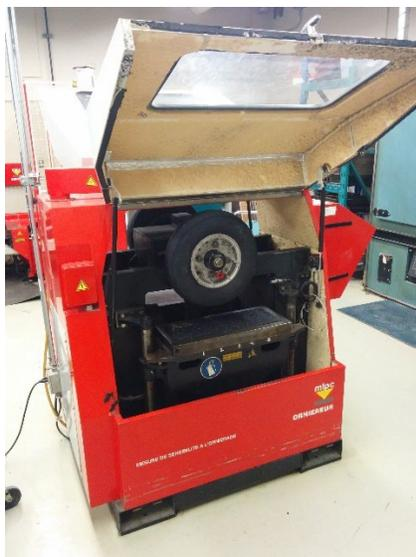
**Figure 7. Appareil de mesure de la résistance à l'orniérage utilisé (orniéreur MLPC + enceinte de chauffage)**
