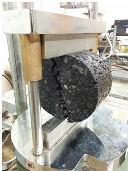
**Figure 9. Essai de résistance à la traction indirecte pour la mesure de la tenue à l'eau**
