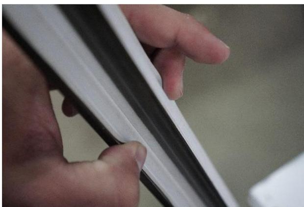
Figure 3.7 Exemple de parclose avec joint intégré, issu des tests effectués
